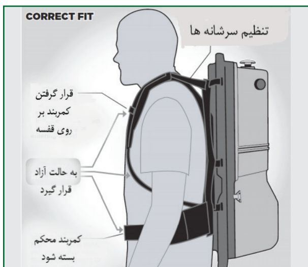
شکل ۵- نحوه صحیح حمل دستگاه الکتروشوکر در هنگام نمونه‌برداری
